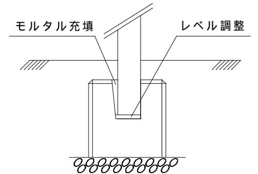
【現場鉄筋アンカー施工参考図】
